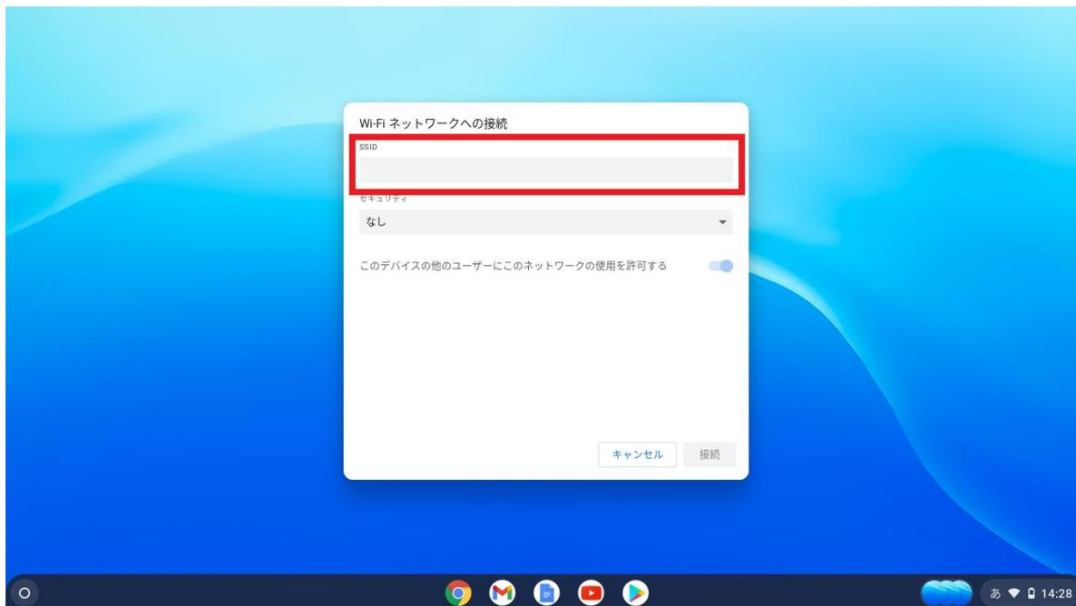
⑤ 「セキュリティ」は、「PSK」を選択し、「パスワード欄」に家庭で使用している Wi-Fi 機器の「パスワード(暗号化キー)」を入力します。
